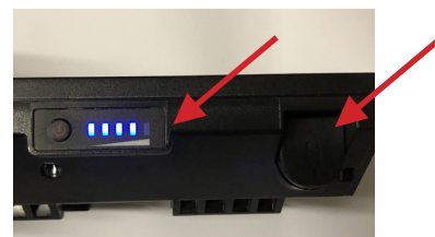
Dioder viser ladetilstand/kapacitet. Opladningsport ses yderst til højre
